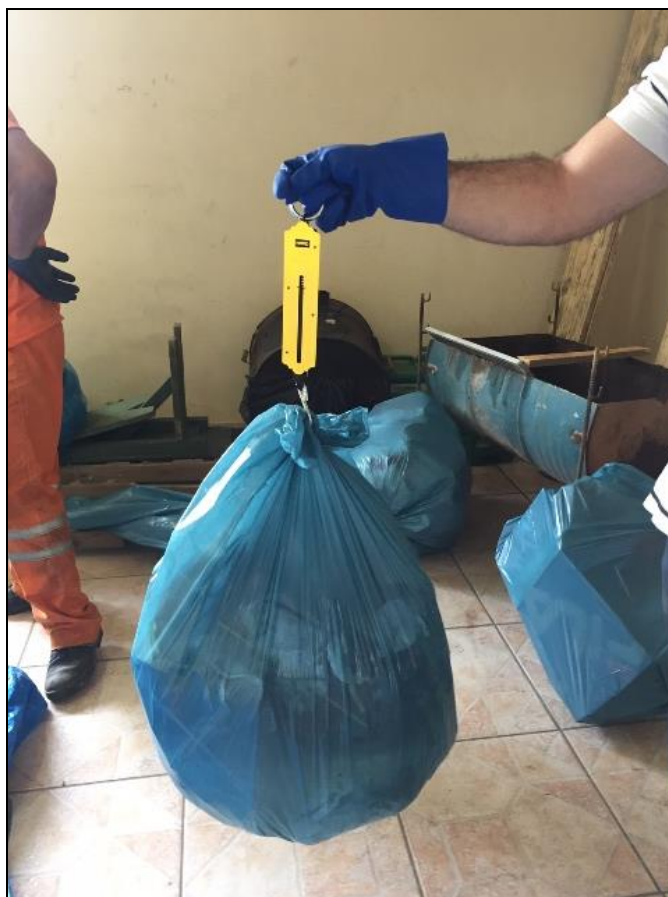
Figura 8 – Pesagem de cada componente da amostra Fonte: Premier Engenharia, 2019.
